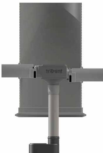
4. Meet het filter en de telescopische buis aan de rustige toevoer en fixeer deze met een boor en de druknagels. De lengte van deze buis wordt bepaald door de tankdiepte. (De rustige toevoer moet op de bodem staan of er een fractie boven hangen.)
